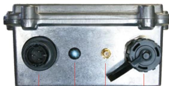
alimentazione LED di stato antenna GSM/GPRS Ethernet
